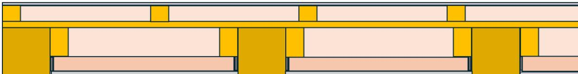
Horizontalschnitt durch eine Fachwerkwand mit zusätzlicher Dämmung innenseitig. Naturheld 140 wird zwischen den Balken eingesetzt und naturheld FLOW oder FLEX als Dämmung in den inneren Gefachen. Die Ständer Innen müssen dabei so gesetzt werden, dass sie als Unterkonstruktion für die naturheld 140 Stücke funktionieren.
