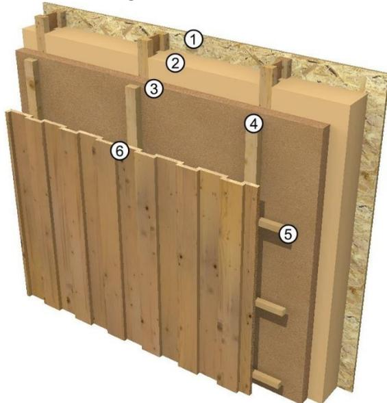
naturheld Dämmung unter einer Fassadenbahn und einer Verkleidung aus Fassadenplatten
