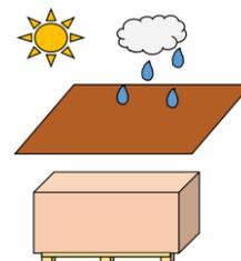
Von den Dämmplatten mit  $140 - 220 \text{ kg/m}^3$  Rohdichte dürfen maximal drei Paletten aufeinandergestapelt werden.
