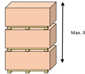
Von den Dämmplatten mit  $110$  oder  $100 \text{ kg/m}^3$  Rohdichte dürfen zwei Paletten gestapelt werden
