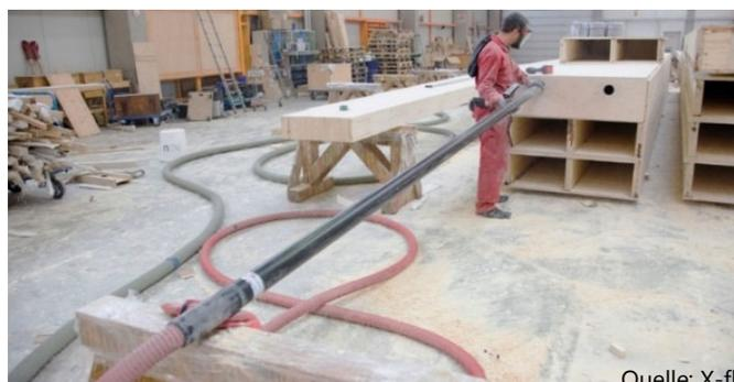
Die Einblasöffnungen werden hier über Schwelle oder Rähm erstellt. Durch das starre Rohr kann eine höhere Rohdichte eingebracht und auch nachverdichtet werden. Zudem ist die Verteilung im Gefach sehr gleichmäßig.
