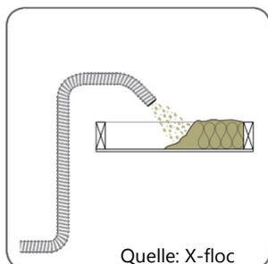
Beim offenen Aufblasen wird der Wärmedämmstoff auf einer nach oben offenen Fläche aufgebracht. Häufig wird so die oberste Geschossdecke oder Gewölbedecken gedämmt. Das Auftragen kann im einfachsten Fall mit einem Schlauch oder mit einem starren Rohr erfolgen.
