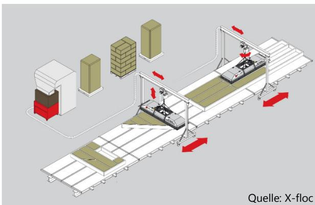
Bei der teil- und vollautomatisierten stationären Befülltechnik werden einseitig beplankte Wand-, Decken- und Dachelemente auf Transporttischen mit einer Einblasplatte von der oberen noch offenen Seite befüllt.
