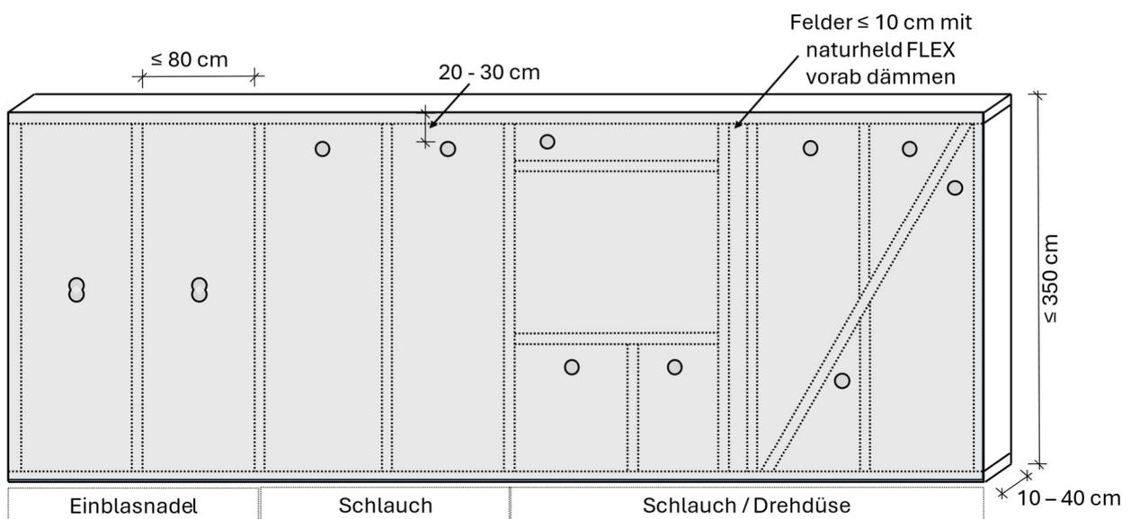
Definierte Bohrungen mit 105 oder 120 mm sind nur bei Verwendung von Verschlussstopfen erforderlich.
