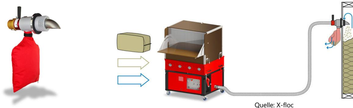
Bei kleinen oder luftundurchlässigen Konstruktionen (z.B. unter Fenstern und Drenpeln, Innenwände etc.) ist es empfehlenswert eine entlüftende Drehdüse zu verwenden.
